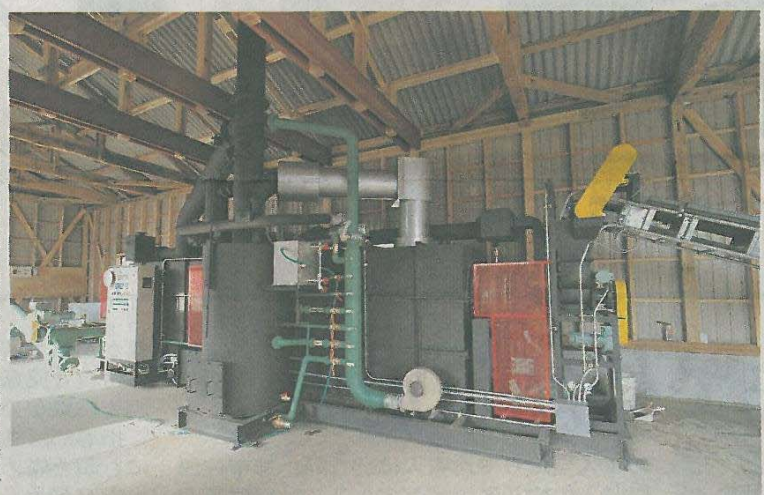
ガイア環境技術研究所が製作し、気仙沼市の会社に納入した炭化加工機。利用状況に応じてオーダーメイドで作る
